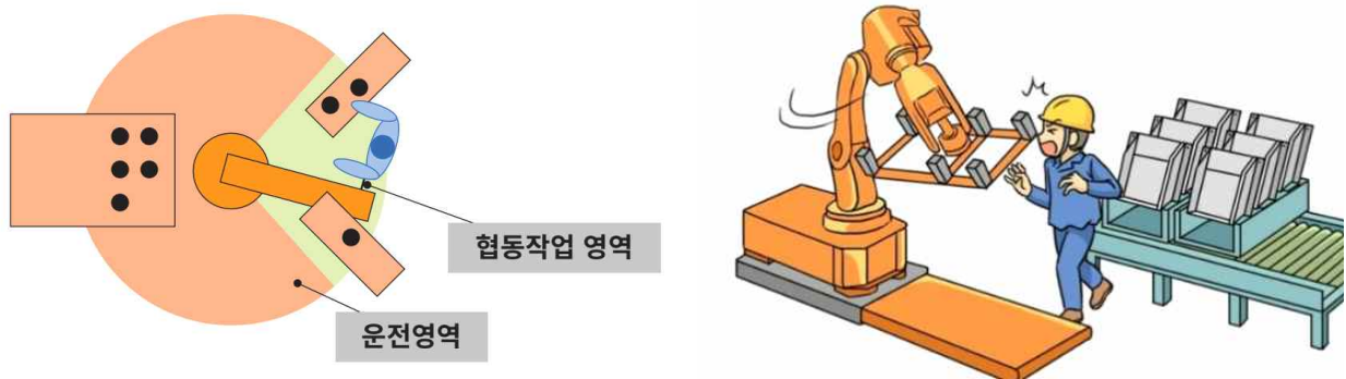
<그림 1> 산업용 로봇과 작업자 협동 영역 구분
