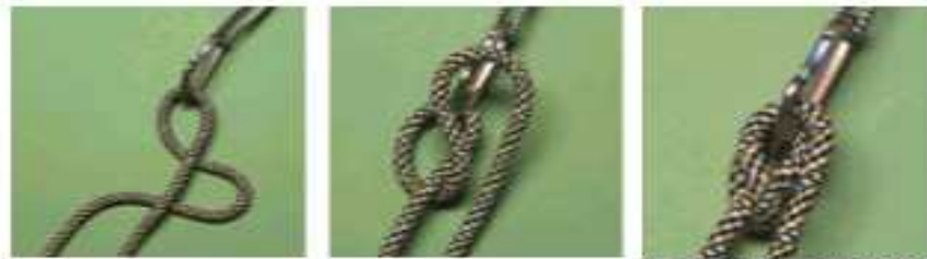
<그림 6> 반(半) 까베스탕 매듭 결속방법(2)
