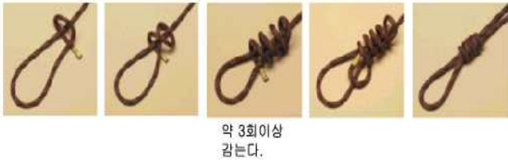
<그림 3> 에반스 매듭 결속 방법
