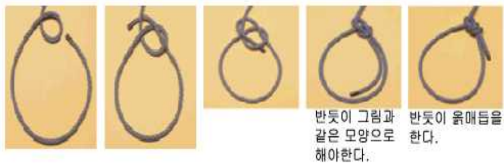
<그림 2> 보울라인 매듭 결속 방법
