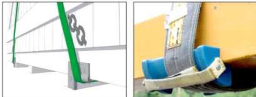
<그림 6> 화물 모서리가 날카로운 경우 받침대 적용 벨트슬링 걸이(예)
