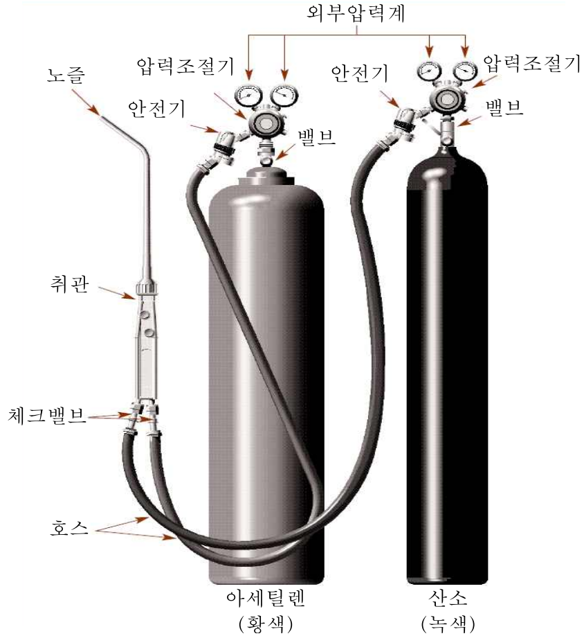
<그림 1> 가스용접 및 절단에 사용되는 전형적인 산소/연료가스 장비
