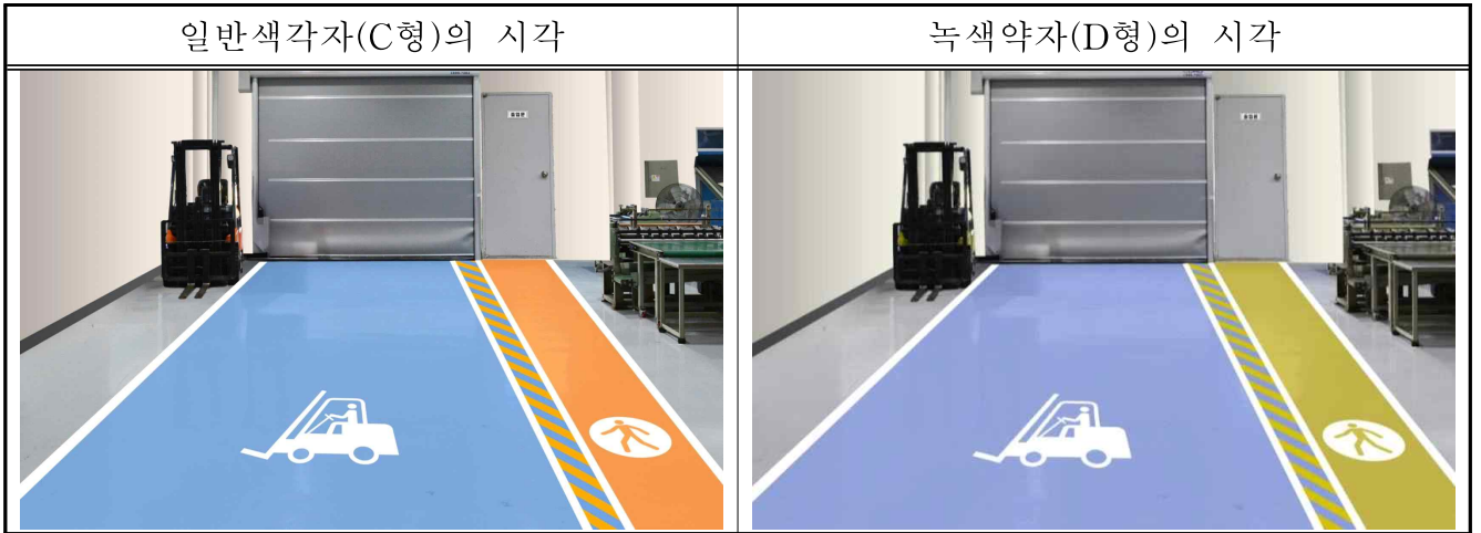
<그림 10> 지게차 주행로, 보행로, 완충면 면 타입 적용 예시 주)
