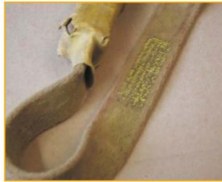
<그림 8> 라벨 분실 및 충격 흡수장치 보호 슬리브 손상 (라벨이 없으면 제품 고유 식별 및 점검 기록 관리가 어렵고, 보호 슬리브 손상으로 장비의 성능이 저하됨)
