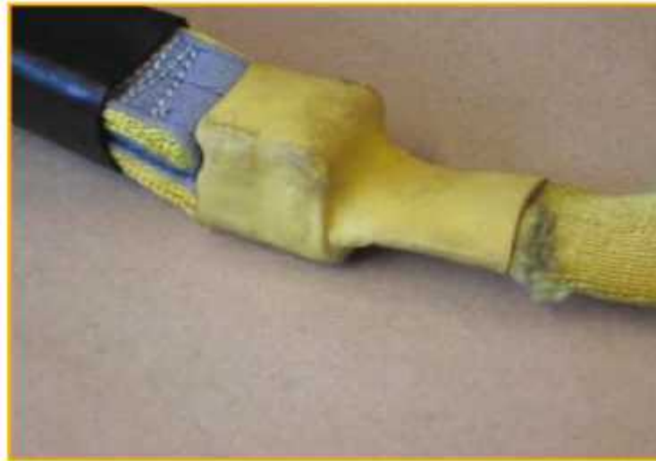
<그림 2> 충격 흡수장치 주변 마모 손상 (보호 슬리브가 원래 위치에서 벗어나 충격 흡수 부위가 노출되어 마모 위험이 커짐)
