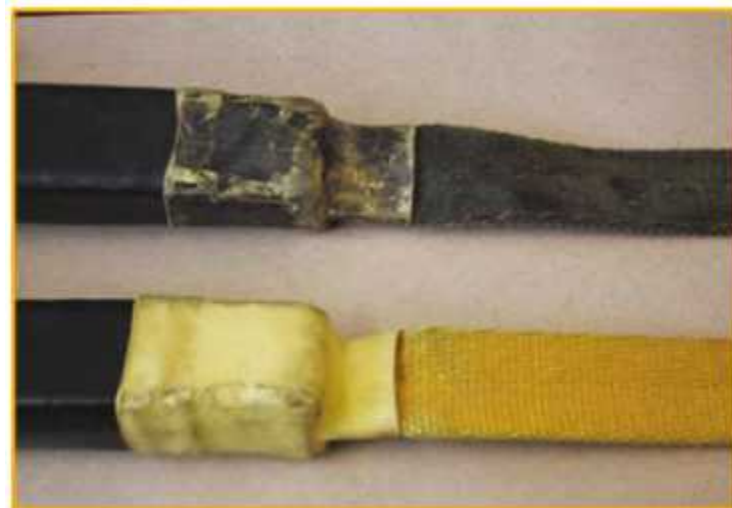
<그림 5> 사용 이력이 불분명한 두 개의 유사한 제품 (제품 상태를 알 수 없을 때 안전성을 평가하기 어렵고, 상단 웨빙 부분이 심하게 오염됨)
