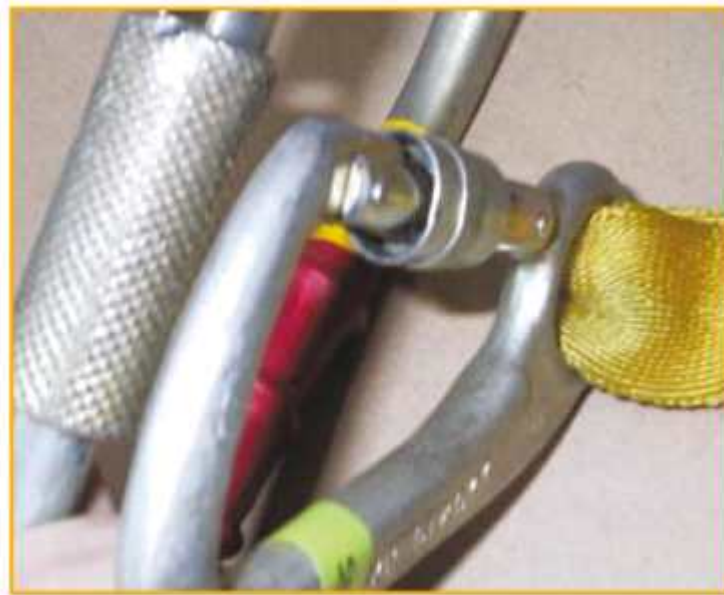
<그림 7> 카라비너의 게이트(Gate) 손상 (연결 부위의 손상은 고정 불량 등 안전사고 위험을 증가시킴)
