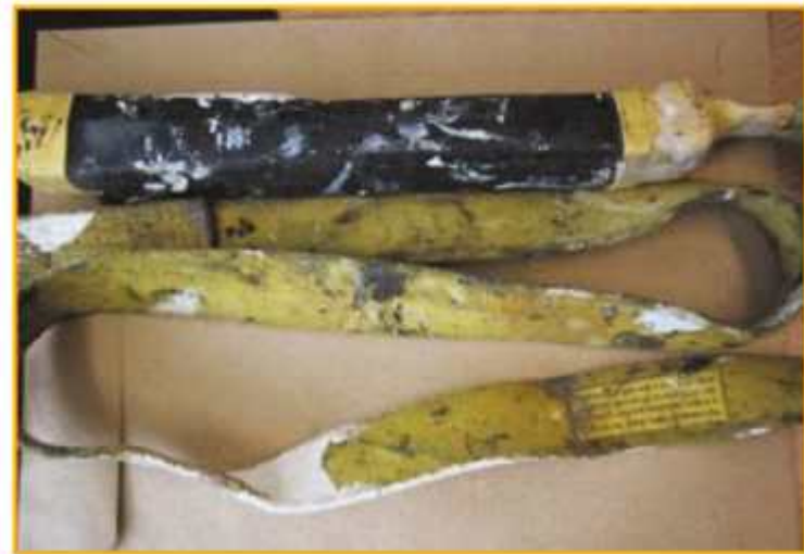
<그림 6> 페인트로 심하게 오염된 웨빙 줍줄 (오염물이 섬유를 심하게 약화시키고 오염 정도에 따라 제품 사용 적합성에 영향을 줌)
