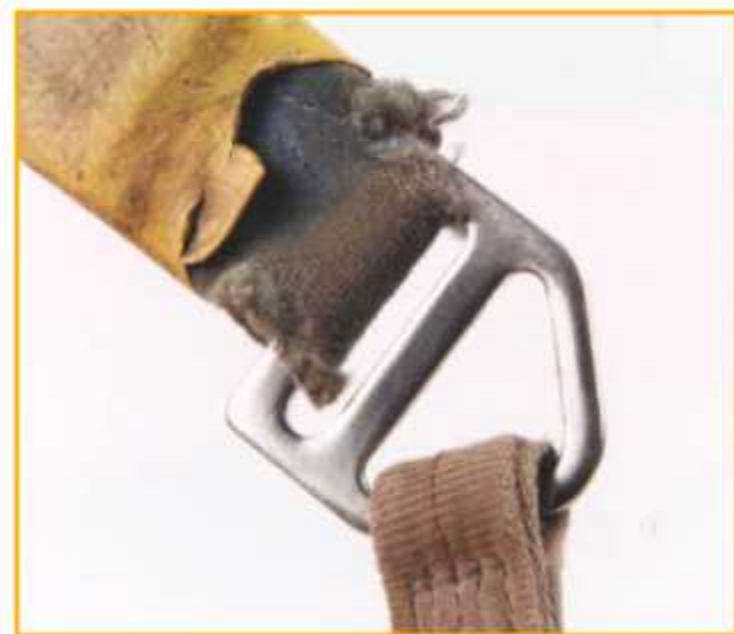
<그림 3> D링 연결부의 충격 흡수장치 루프 끝부분 마모 (충격 흡수장치 연결부의 마모는 장비 강도 저하 및 파손 위험으로 이어짐)
