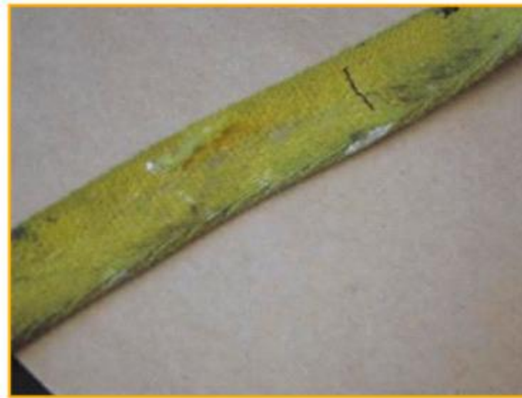
<그림 4> 마모로 인한 표면 섬유 손상 (웨빙 표면 섬유가 마모, 마찰 등으로 약해져 쉽게 파손될 위험이 있음)
