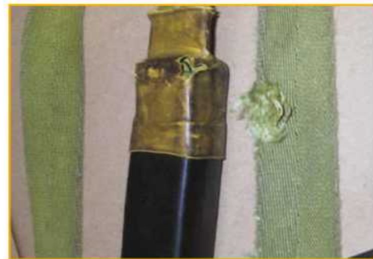
<그림 1> 손상된 웨빙 줍줄 및 충격 흡수장치 보호대 (충격 흡수장치를 감싸는 보호대 및 웨빙 자체의 손상으로 인해 안전성이 저하됨)
