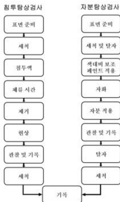
<그림 1> 자분탐상검사와 침투탐상검사의 진행 과정
