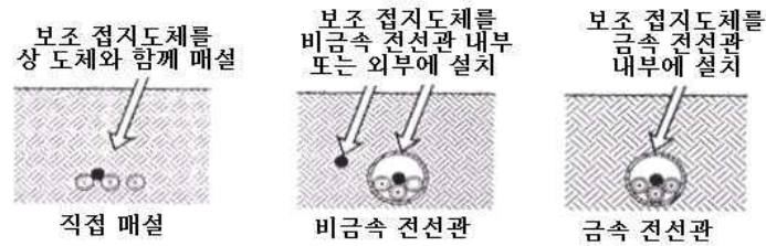
<그림 7> 보조 접지도체의 설치방법
