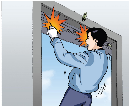
<그림 15> 출입문 유압장치 실린더에 의한 사고
