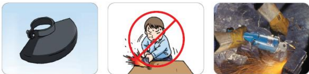
<그림 30> 그라인더 사용 시의 베임 사고 예방대책
