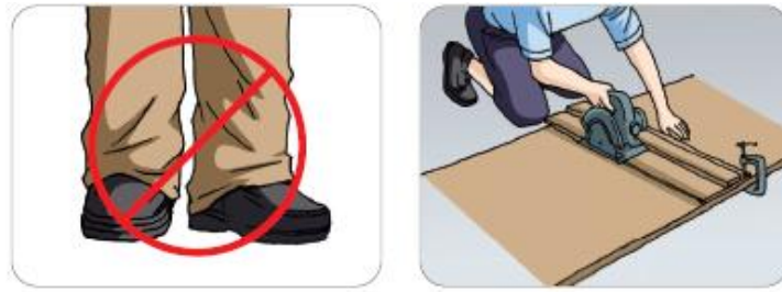
<그림 28> 전기톱 사용 시 톱날에 의한 베임 사고 예방대책
