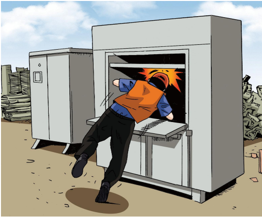
<그림 5-13> 압축기 밑판에 의한 부딪힘
