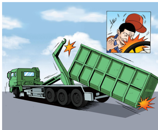
<그림 5-15> 암롤트럭에 의한 부딪힘
