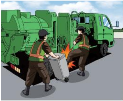
<그림 4-23> 수거차량 리프트 버튼의 오작동에 의한 끼임
