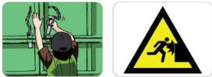
<그림 4-40> 적재함 문과의 부딪힘 방지를 위한 예방대책
