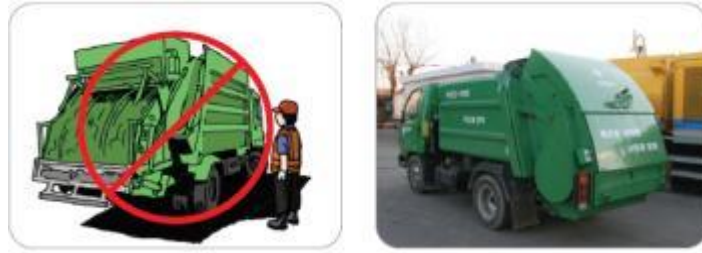
<그림 4-30> 청소차량의 압축판 레일에 끼임에 대한 사고 예방대책
