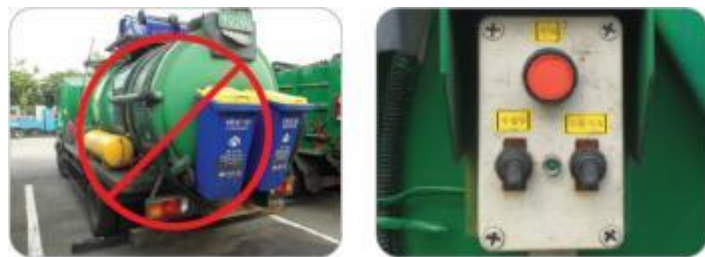
<그림 4-29> 수거차량 리프트 버튼의 오작동에 의한 끼임에 대한 사고 예방대책
