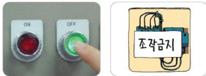
<그림 5-16> 압축기 밀판에 의한 부딪힘 사고 예방대책
