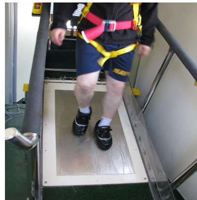
(그림 1) 경사로(ramp tester) 시험기 구조 및 사진
